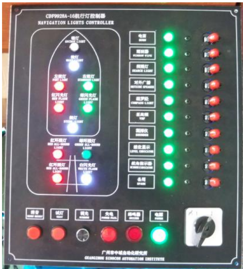
图二、 CDF9928A-16 航行灯控制器正面布置图
